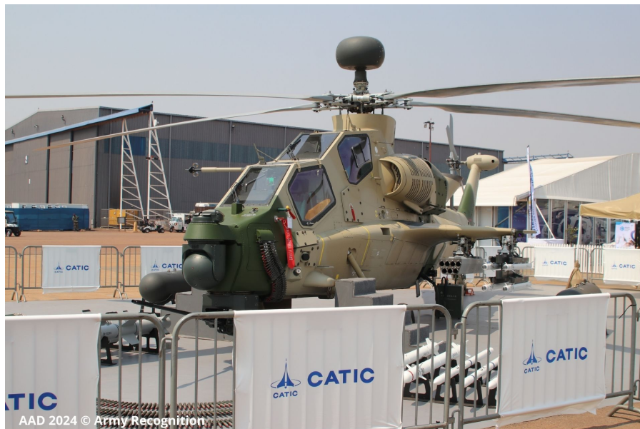
Хеликоптер Z-10ME сада користи WZ-9G мотор, замењујући ранију WZ-9 који повећава излазну снагу са 1.250 КС на 1.500 КС. (Извор фотографије: Army Recognition)
