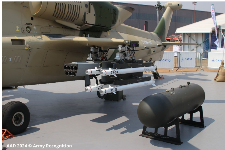
Наоружање Z-10ME чине топ калибра 23 мм и четири спољне подвесне тачке, са носивошћу до три тоне. (Извор фотографије: ArmyRecognition)
